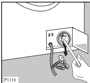
Înfiletați la loc capacul furtunului de evacuare de urgență și plasați-l în locasul sau.
