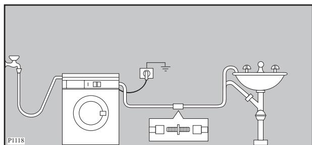
Pentru o funcționare corectă a mașinii de spălat furtunul de evacuare trebuie să rămână fixat pe suportul corespunzător din partea de sus din spatele mașinii de spălat.
