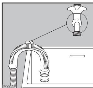
**A mosdókagyló kivezetésének egyik leágazásához csatlakoztatva.** Ennek a leágazásnak a szagelzáró fölött kell elhelyezkednie ily módon, hogy a cső könyök része legalább 60 cm-re legyen a talajtól.
